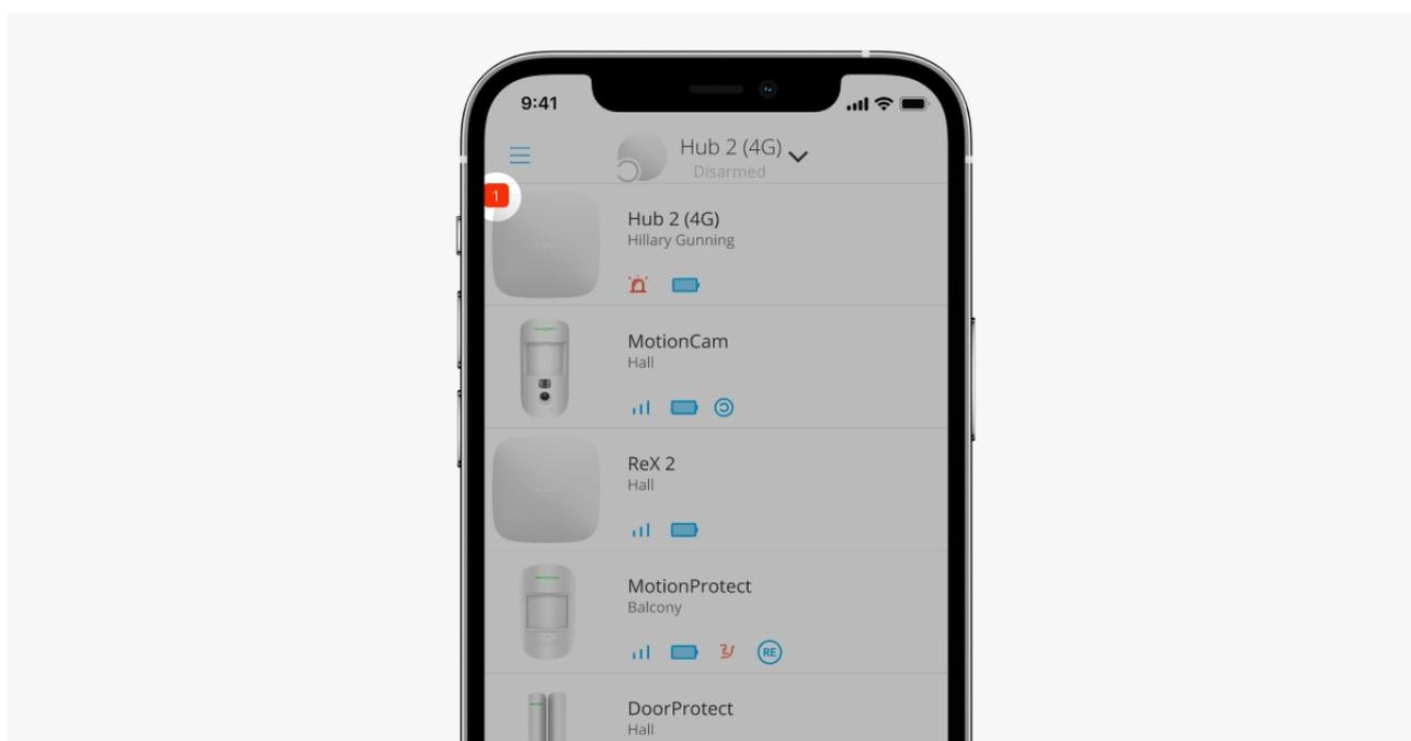
Si une erreur est détectée au niveau de la centrale (par exemple une absence d'alimentation externe), un compteur de dysfonctionnements s'affiche sur l'icône de l'appareil dans l'application Ajax.
